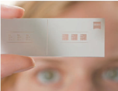
Mit dem Auflösungstest-Objekt 3000 prüfen Sie die tatsächliche Auflösung Ihres Stereomikroskops.
