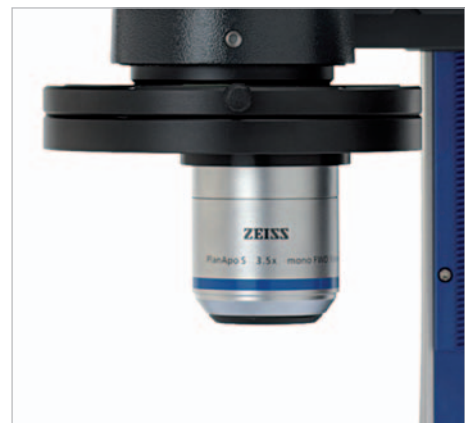
Objektiv PlanApo S 3.5x mono am Objektivschlitten S/doc ■ zur einkanaligen Nutzung (z.B. Axial-Mode) ■ Freier Arbeitsabstand FWD=16mm ■ max. mögliche Auflösung von 1510 LP/mm (entspr. 0,3 µm)
