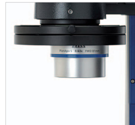
Objektiv am Objektivschlitten S/doc ■ in Axial-Modus
