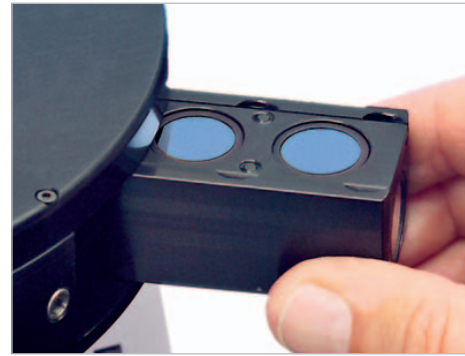
Mit einem Handgriff wechseln Sie die Filterblöcke am PentaFluar S.
