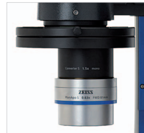
Tandem mono Kombination am Objektivschlitten S/doc zur einkanaligen Nutzung (Axial-Modus)
