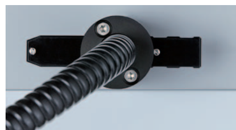
Position 3 ■ Schieber in Endlage „Auflicht-Reliefkontrast“ ■ diese Endlage ist in beide Richtungen möglich ■ Beleuchtungsrichtung jeweils um 1^\circ gekippt
